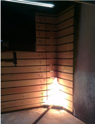
SBI test met een horizontale open gevelbekleding
